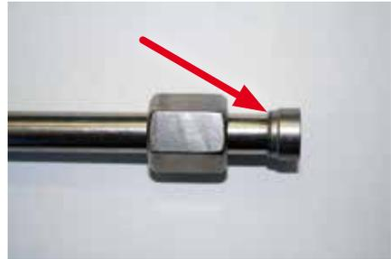
Die Dichtflächen der Klemmringe dürfen keine Eindrücke oder exzentrische Abdrücke aufweisen.
